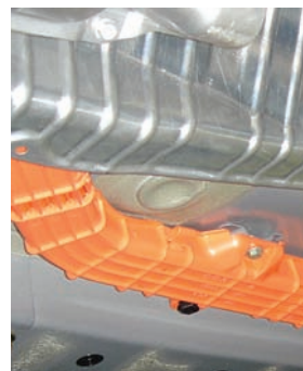
Bouclier haute tension boulonné à la carrosserie
