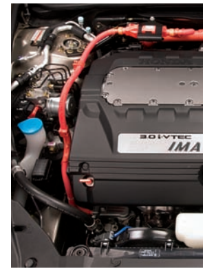
Câble haute tension du compresseur du climatiseur de l'Accord
